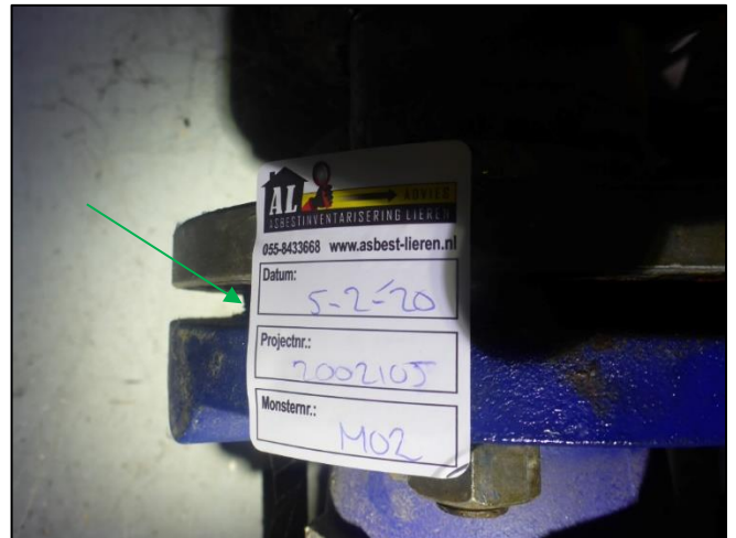
Foto 10: Technische ruimte: Flenspakkingen (Bron 2)
