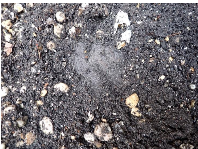
Foto 9 Vervuiling op filtervlies.
