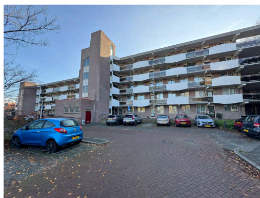
Nabij de entree is voldoende ruimte voor de opstelplaats van een tankautospuut van de brandweer
