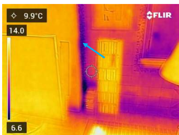
Openstaande aansluiting van de voorzetwand op de gevel voor de toegang in de westgevel.
