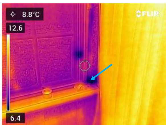
Lekkage langs de voorzetbeglazing.
