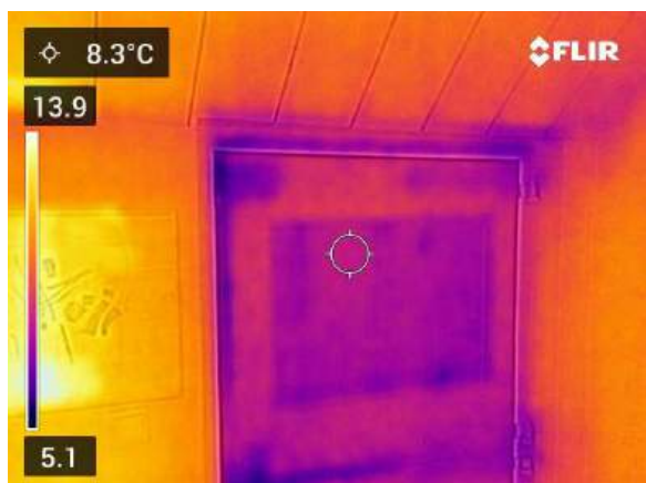
Openstaande aansluitingen rondom de toegang.
