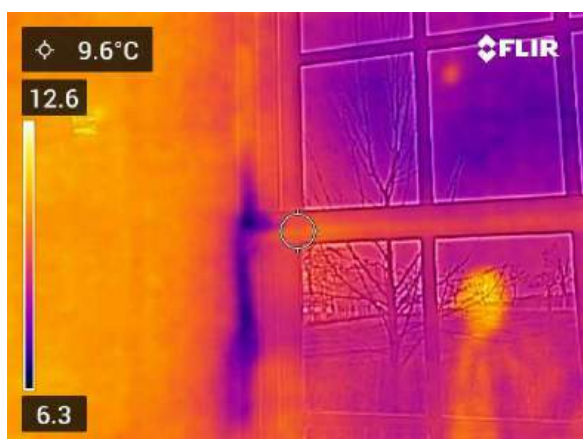
Lekkage langs de voorzetbeglazing.
