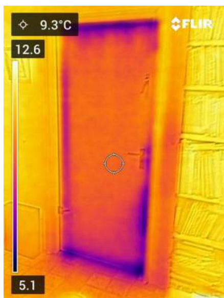
Openstaande aansluitingen bij de tussendeur naar het ongeïsoleerde achterhuis.
